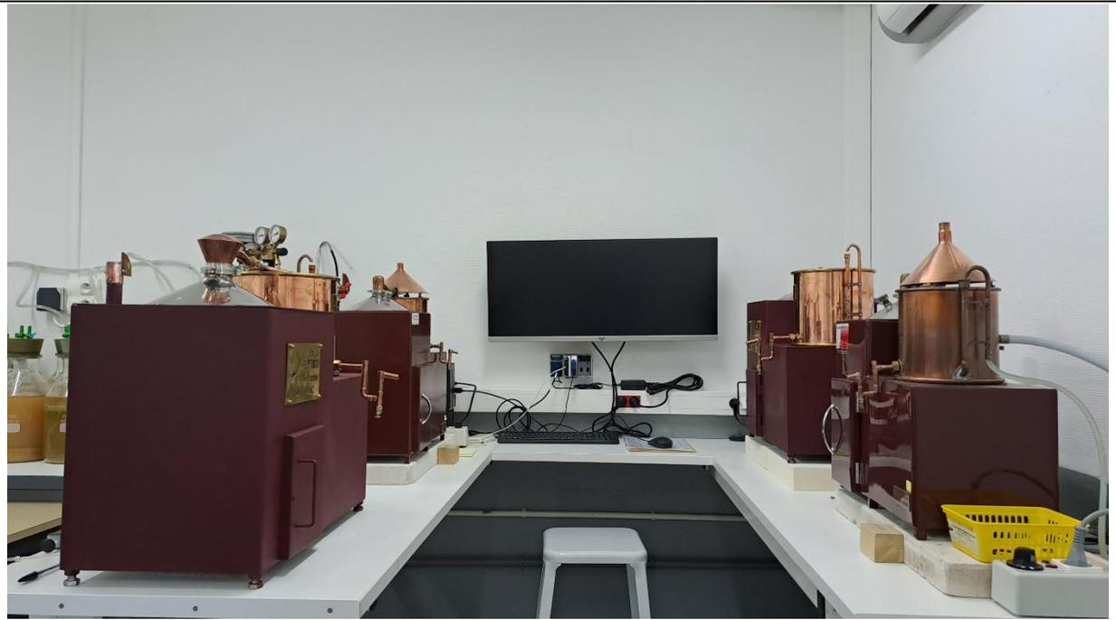
**Equipement de micro-alambic de 1 litre et 3 litres avec automate informatisé
