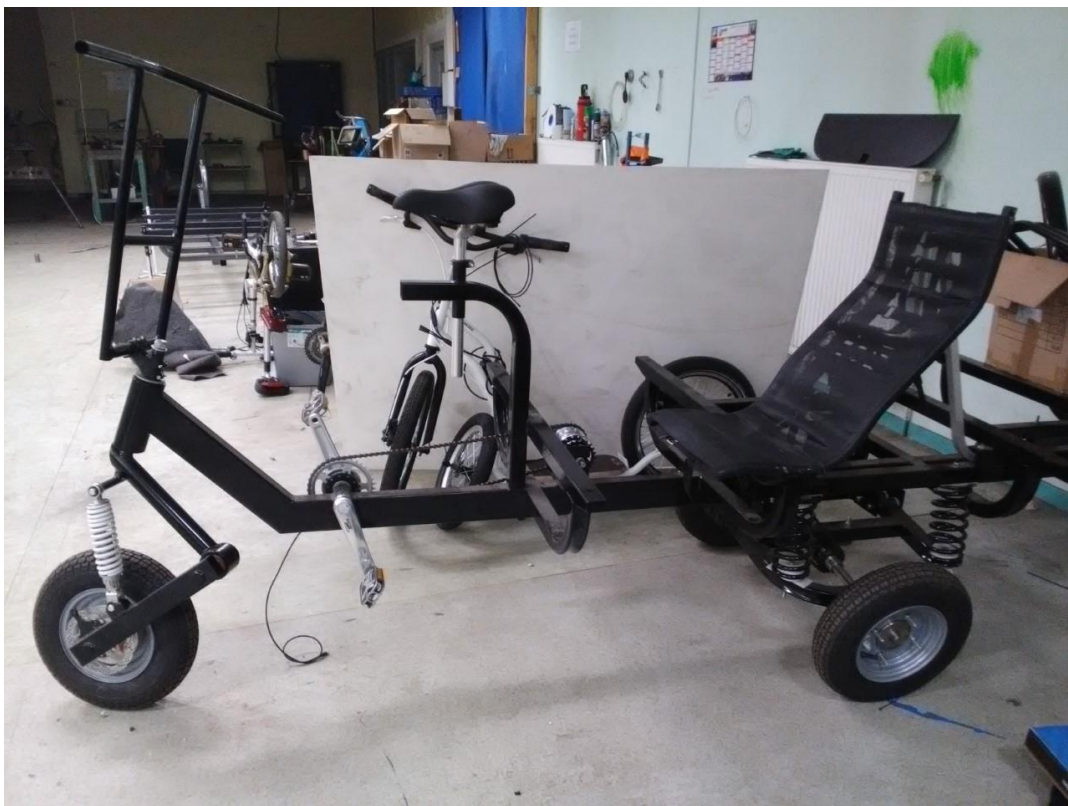
Le projet : prototype du triporteur électrique réalisé sur mesure
